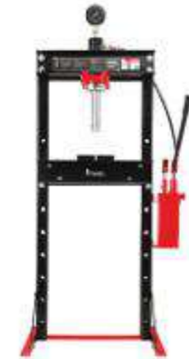
ΠΡΕΣΣΑ Η-370 20ton με κινητό έμβολο
